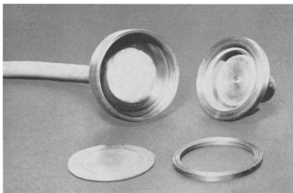
Abb. 12. Messingapparatur zur Abdrucknahme von Polystyrolabdrücken unter Vakuum. Die Apparatur hat einen Durchmesser von 7 cm
