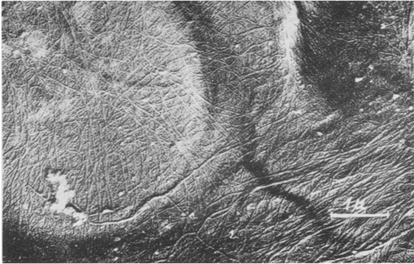
Abb. 7. Fichtensulfitzellstoff, Hoftüpfel, Polystyrolwärmeabdruck, palladiumbeschattet, Kohlefilm. Vergrößerung: 15 000fach
